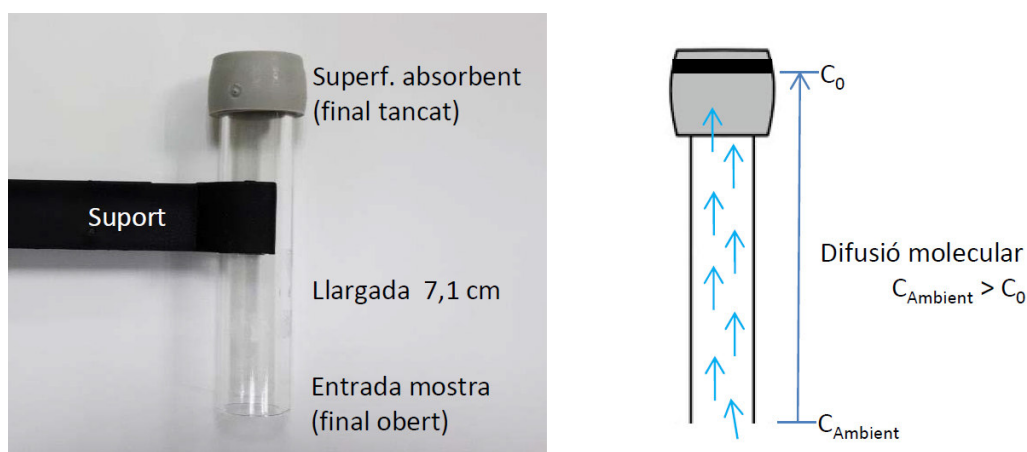
Figura 1: Principi de funcionament dels tub passius de difusió de \text{NO}_2 de tipus Palmes, on C_{\text{Ambient}} és la concentració de la mostra ambiental i C_0 és la concentració a la superfície de l'absorbent.
