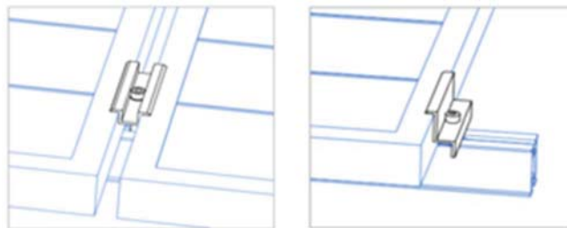
Detalle Bidas Fijación Placas PV
