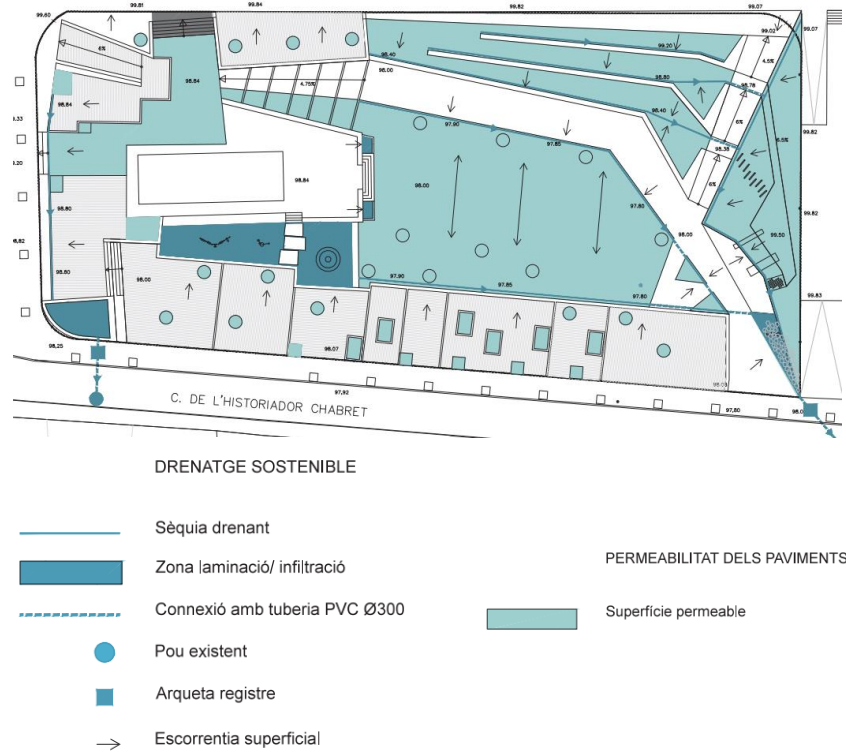
Figura 29. Plano de distribución de zonas permeables, impermeables y zonas de laminación en la plaza de la Ermita de San Jerónimo.
