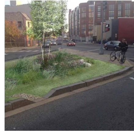
Figura 50. Simulación gráfica de incorporación de una zona de biorretención en red viaria de pequeño tamaño. Fuente: adaptación de Washington DC Department of Transportation (2014).
