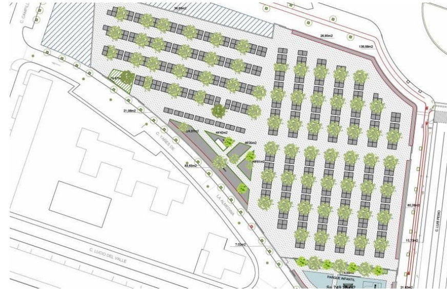
Figura 25. Plano en planta del nuevo rastro. Se destaca en gris oscuro las zonas con baldosas permeables y en rojo las zanjas de infiltración.
