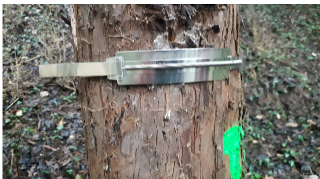
Dendòmetre instal·lat. Foto: Arxiu XPN
